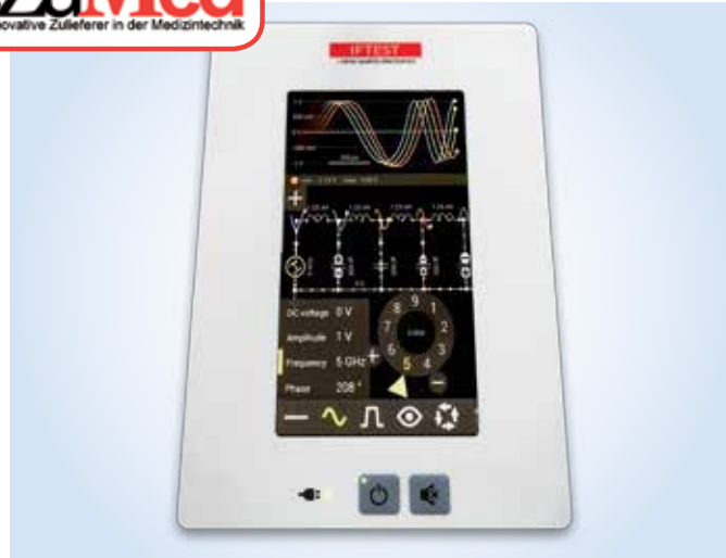
Vollgrafische Bedien- und Anzeigeeinheit mit Touchdisplay: Für die Front kann preiswerte Dekorfolie oder hochwertiges Glas verwendet werden.
